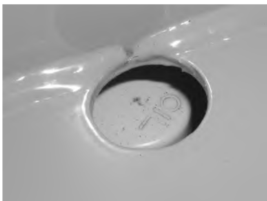
Punto di rifornimento olio del differenziale
